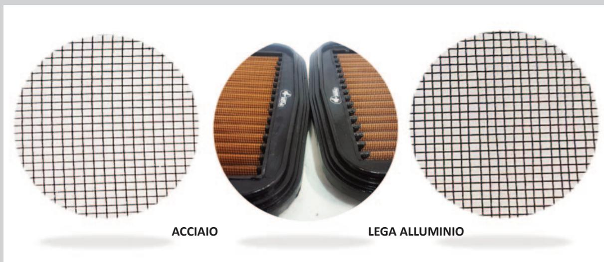
Nessun aggravio di peso è causato dall'impiego dell'acciaio rispetto alla lega leggera: oltre alla trama più larga, il diametro del filo utilizzato è inferiore rispetto alla passata struttura e questa cosa compensa abbondantemente il maggiore peso specifico. In ultimo anche il look dei filtri ne risulta migliorato: si evidenzia meno trafile di poliuretano sulla mappa filtrante (di colore arancio per i P08, nero per i P08F1-8, bianco per il T12 e il T14) che risulta molto più definita.
