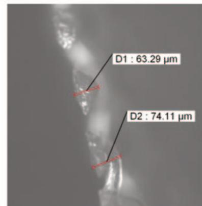
Analisi dell'elemento filtrante SF P08 con zoom 10x. L'immagine mostra chiaramente l'uniformità del tessuto. La mancanza d'imperfezioni della struttura consentono l'utilizzo di un singolo strato filtrante. Spessore delle fibre= 68 µm - Area maglia= 8184 µm<sup>2</sup>
