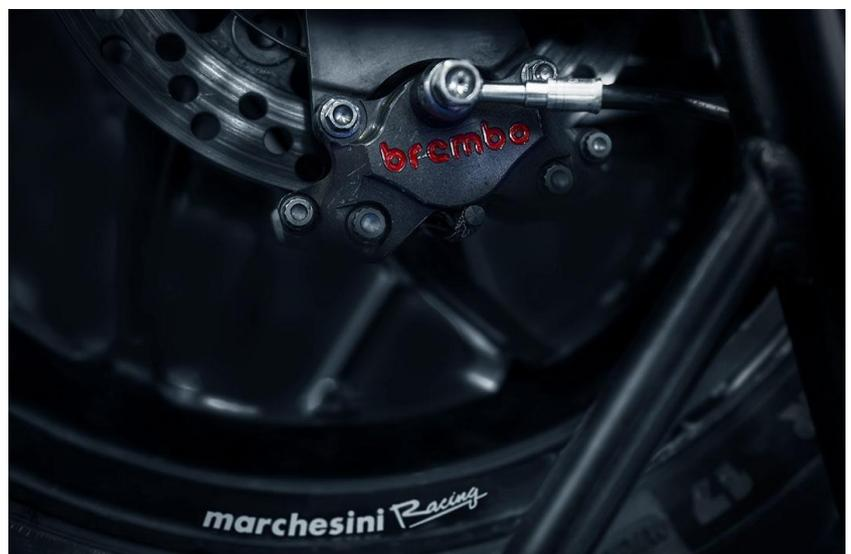
I cerchi M7R Genesi dispongono di 7 razze costituite da una lega di magnesio impiegata per applicazioni aerospaziali lavorata attraverso una forgiatura multi-direzionale e l'uso di stampi ottimizzati sulla geometria finale della ruota: la riduzione di peso rispetto ai cerchi di serie va dal 26 al 41 per cento a seconda del modello di moto.
