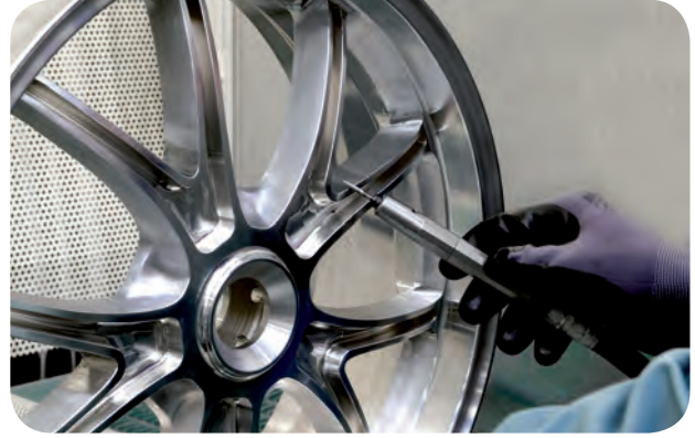
Sbavatura finale manuale Final hand finishing
