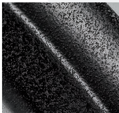
Trattamento ANTISLIP sui bordi del canale (optional).
