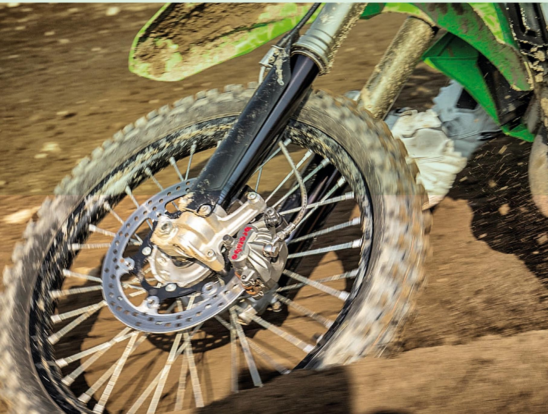
Qui sopra, il protagonista del nostro test: il nuovo impianto frenante Brembo in versione "giapponese", ovvero installabile su tutte le Cross del Sol Levante,
